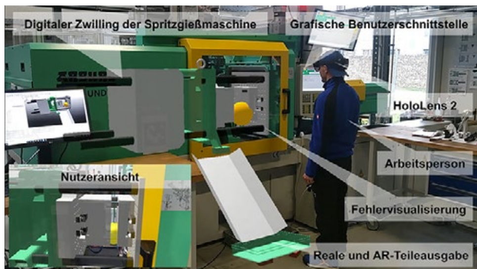
Visualisierung des Dieseleffekts in AR durch das FeDiNAR-System nach fehlerhafter Programmierung an einer Arburg-Spritzgießmaschine des ikuowl in Lemgo.
